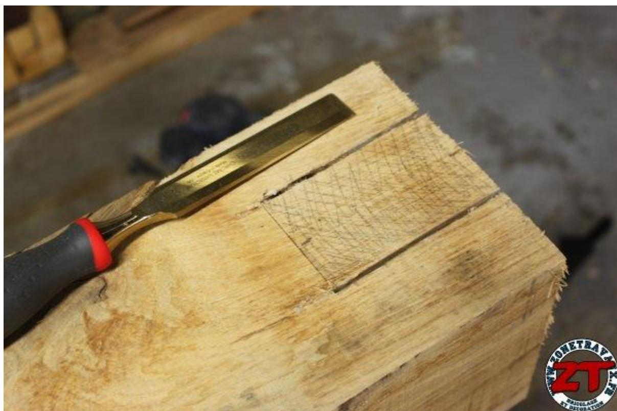
A l'aide de ma scie à onglet, je réalise 2 encoches sur le poteau et l'excédent de bois sera retiré à l'aide d'un ciseau à bois. C'est une étape légèrement fastidieuse mais qui permet d'avoir un rendu vraiment propre et précis.
