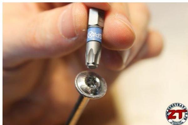
Au niveau des vis, je suis parti sur des vis permettant un serrage maximal, [les SPAX T-STAR plus](#) :
