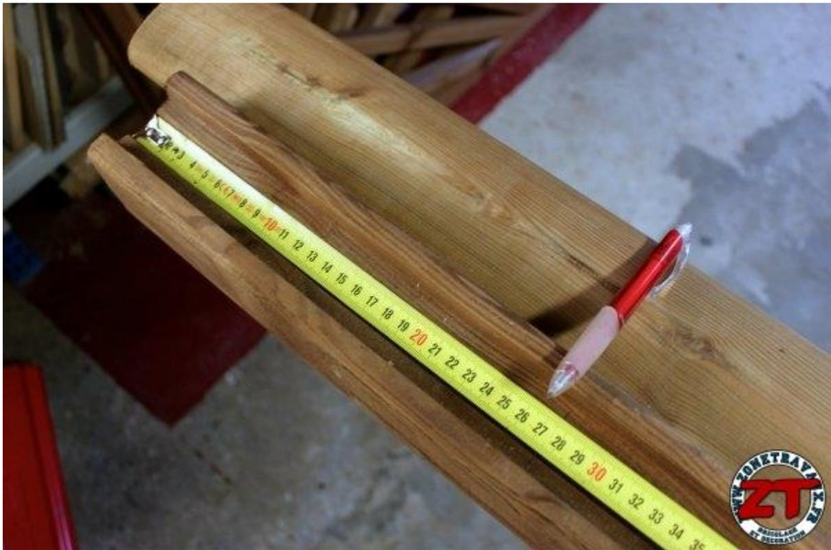
La découpe est réalisée avec la scie à onglet. La lisse inférieure est plus épaisse et dispose d'une gouttière pour évacuer l'eau de pluie (il faudra penser à percer un trou pour l'écoulement dans le cas où vous avez retiré la section qui disposait de ce trou).
