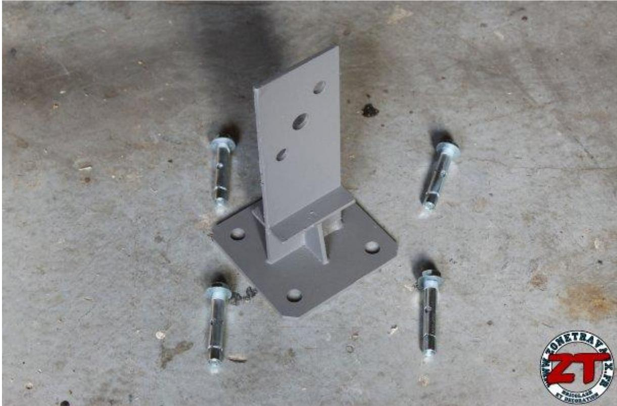
Le principe est de réaliser une encoche dans le poteau et d'insérer la platine à l'intérieur. Ensuite, un boulon tête ronde (traversant tout le poteau) viendra fixer le pied dans le poteau. Je positionne donc le pied au niveau du poteau et trace la future découpe au crayon à papier.
