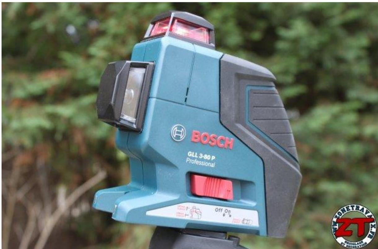
J'ai installé celui-ci sur un trépied de photo (pas de vis universel) puis ajusté à la hauteur à laquelle je viendrai fixer le bastaing. Le bastaing sera placé le plus haut possible par rapport à la gouttière (attention une gouttière est installée avec un léger angle pour l'écoulement de l'eau).
