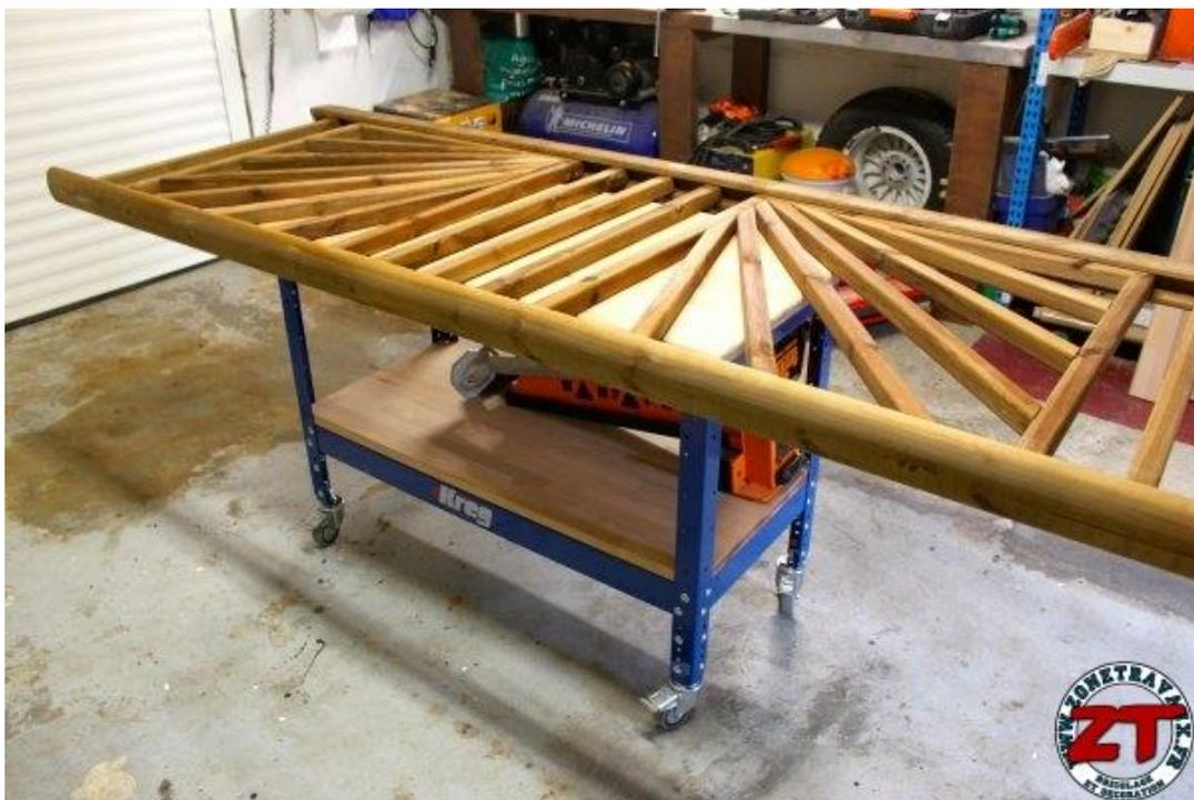
Petit focus sur le système de fixation des différents éléments en bois, nous sommes sur un montage par vissage en biais (exactement comme [mon gabarit de perçage](#)). C'est un système simple, solide et invisible. Je suis juste un peu déçu du niveau de finition car, à ce prix, j'aurais aimé qu'ils ébavurent le perçage du bois... tant pis, je le ferais moi même !
