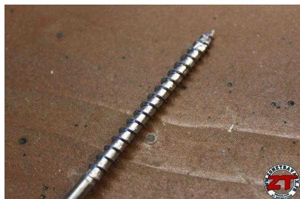
Pour choisir la bonne vis pour l'assemblage des différents éléments, c'est très simple. Il suffit de connaître l'épaisseur de l'élément que vous souhaitez fixer à la structure. La pièce sans filetage doit atteindre complètement la pièce supérieure. Puis, la tête assiette visse fermement la pièce supérieure à chaque rotation de filetage à la pièce sous-jacente.
